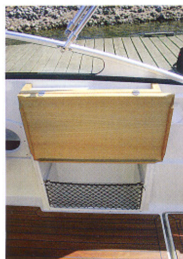
Q-pantryet gemmer sig ind mod styrbord skot. Det løftes op, og dermed trykkes både et blus, en opvaskekumme og ferskvand frem. Smart løsning til helt enkel servering i cockpitet.
