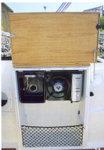
Q-pantryet gemmer sig ind mod styrbord skot. Det løftes op, og dermed trykkes både et blus, en opvaskekumme og ferskvand frem. Smart løsning til helt enkel servering i cockpitet.
