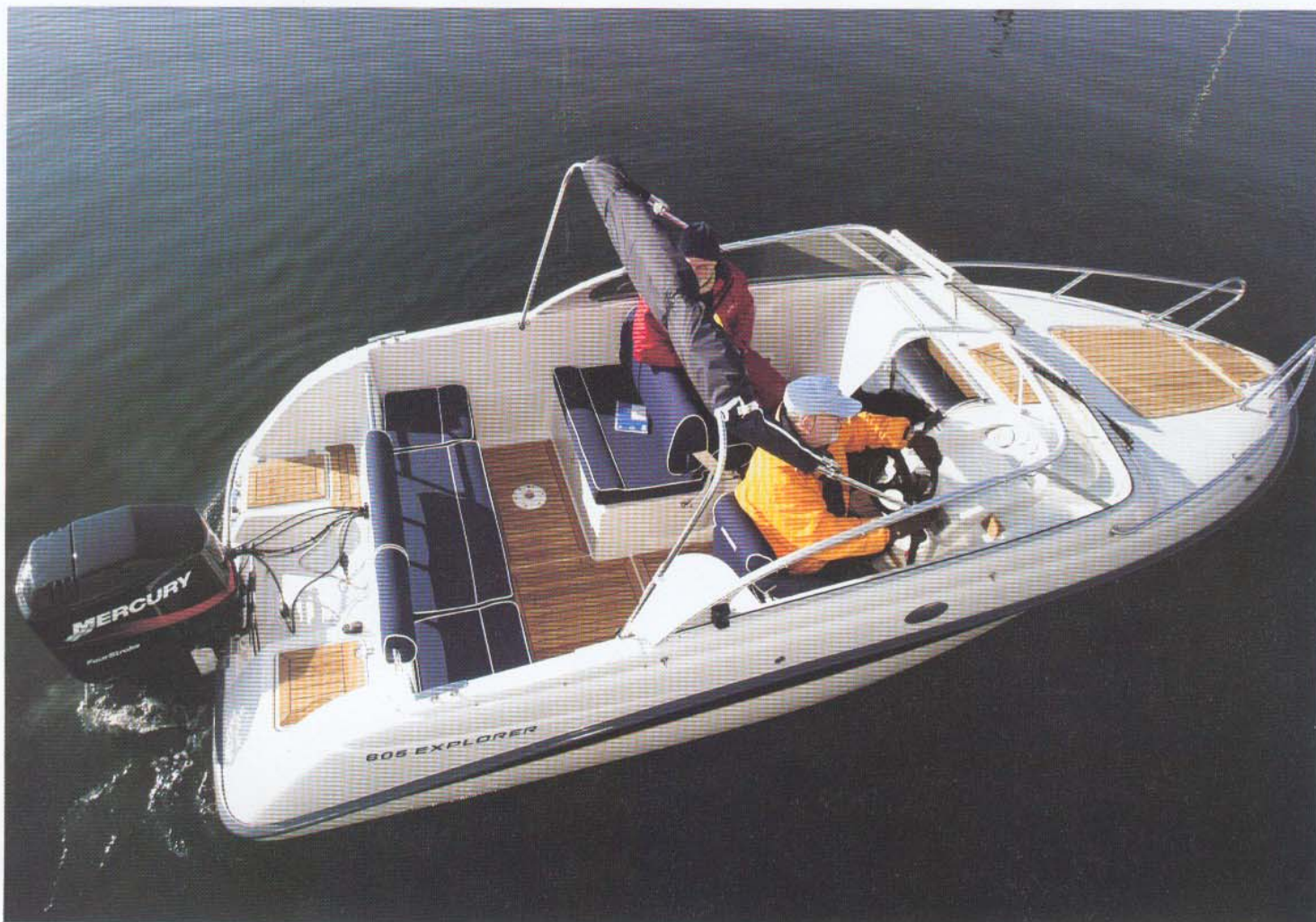
Smalle cockpitarme sikrer optimal størrelse på cockpitet. Passagerstolens konsol danner fundament for en god solseng.
